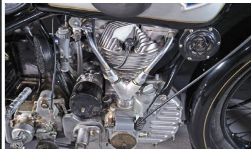
Teuer und gern undicht: die hydrostatische Ventilsteuerung am Prototyp
