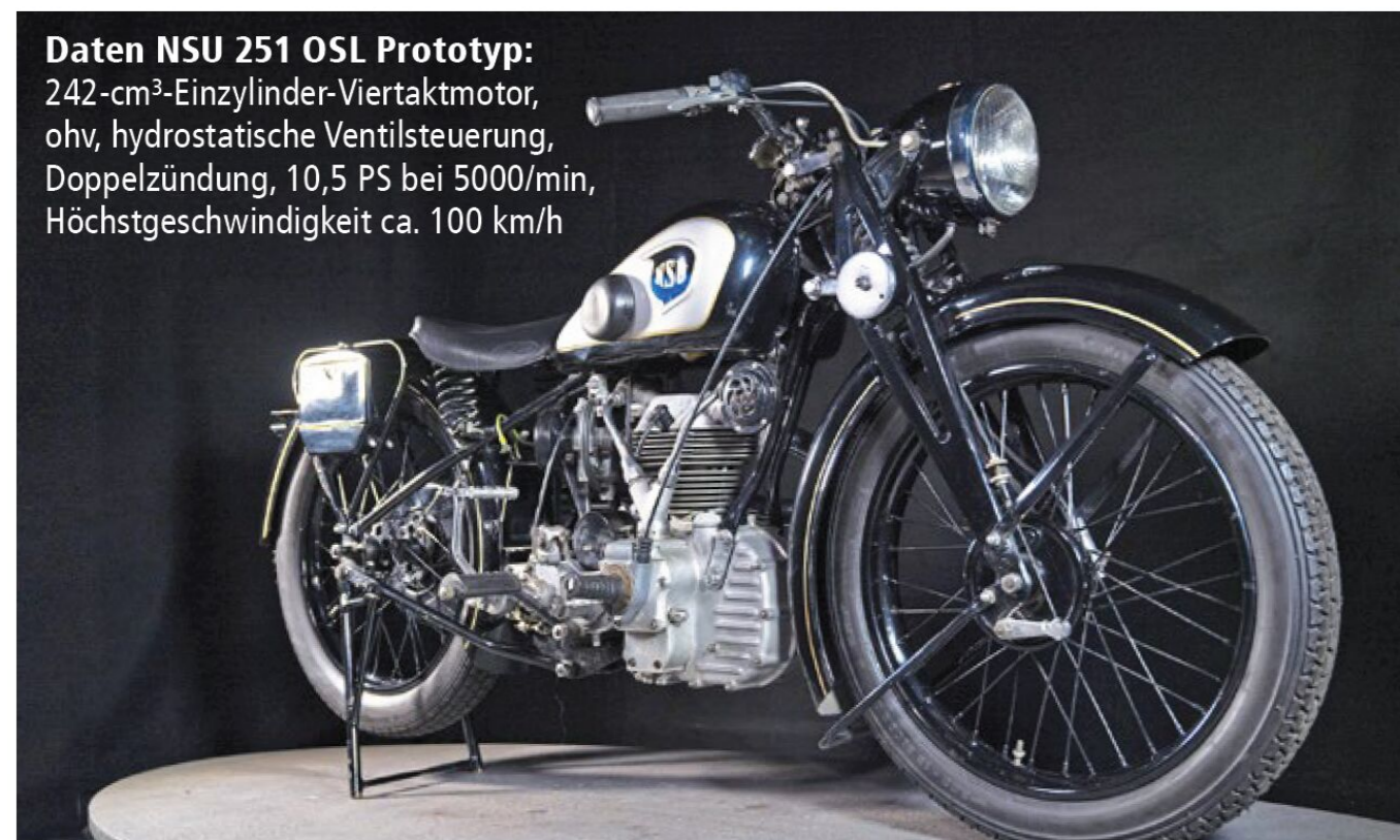
Teuer und gern undicht: die hydrostatische Ventilsteuerung am Prototyp
