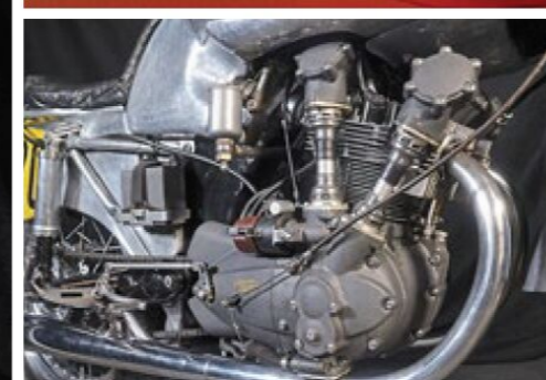
Gleich zwei Königswellen steuerten die Ventile des Zweizylindermotors
