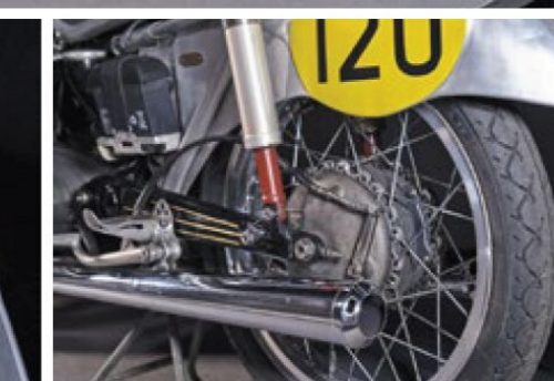
Federung und Rahmen der Rennmax wichen stark vom Serienmodell ab
