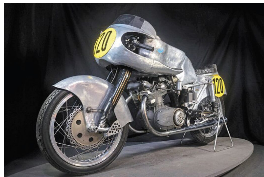
Im Gegensatz zum späteren Max-Serienmodell mit Einzylinder wurde die Rennmax von einem Paralleltwin befeuert
