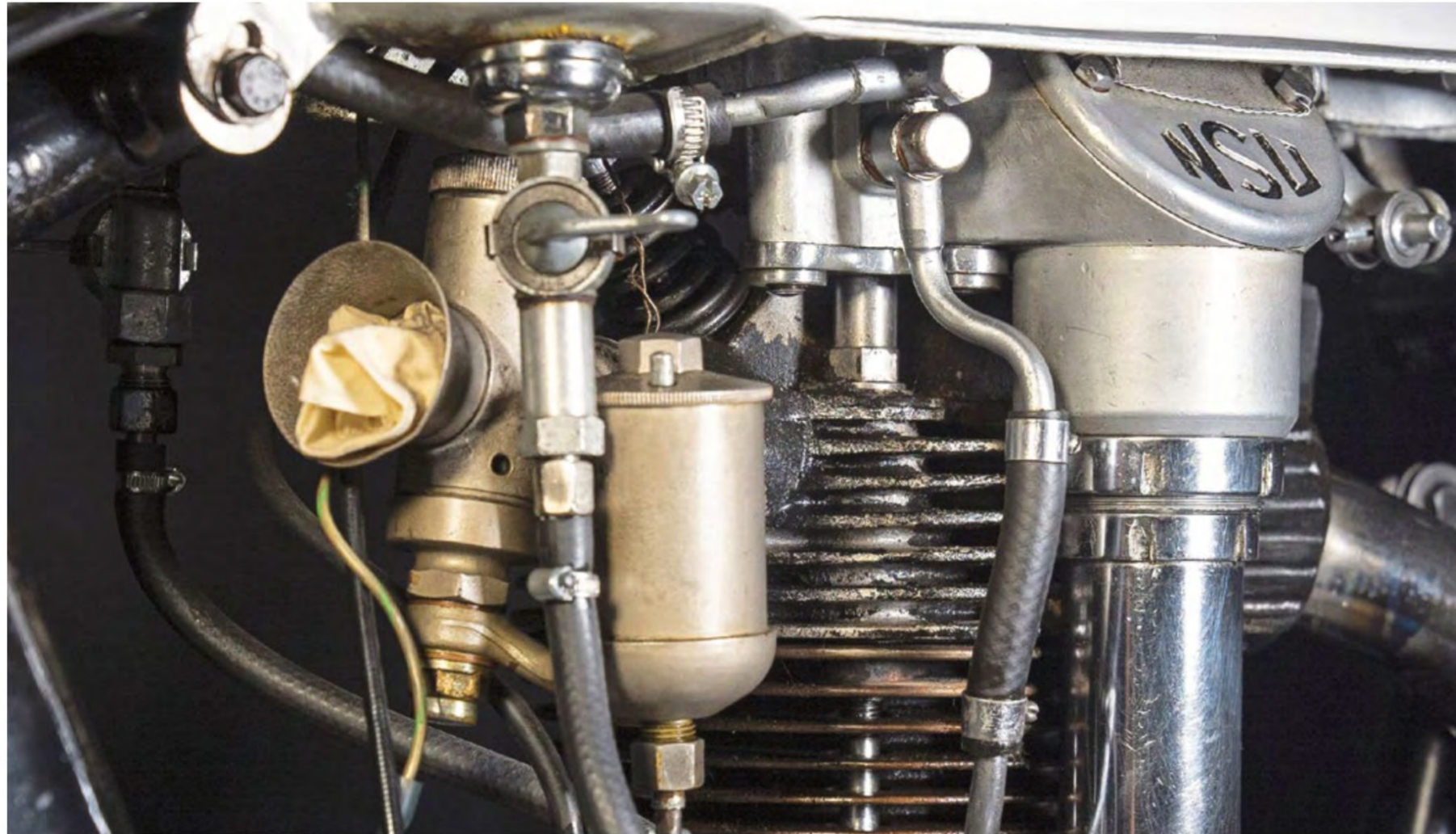
Der beim hier gezeigten Exemplar verbaute Zylinder besteht im Gegensatz zum Original aus Aluminium und stammt aus einer späteren Nachfertigung. Neben der 500er gab es für die größeren Klassen auch einen 600er-Werksrenner mit längerem Hub
